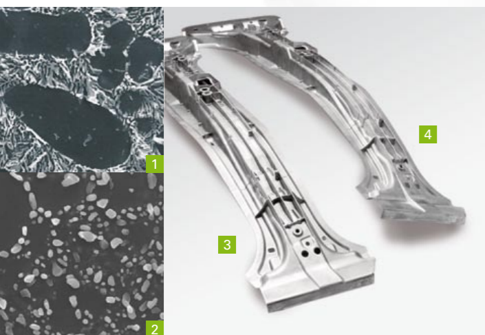
Morphologie des eutektischen Siliciums Abb. 1: im Gusszustand Abb. 2: nach Wärmebehandlung mit einem ideal eingeformten eutektischen Silicium
